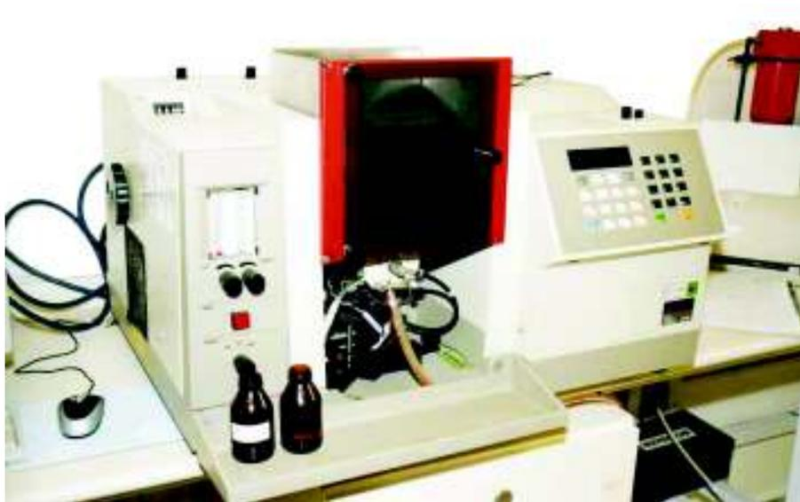
Espectrofotómetros de Absorción Atómica (AA) con atomizadores por llama (FAA).
