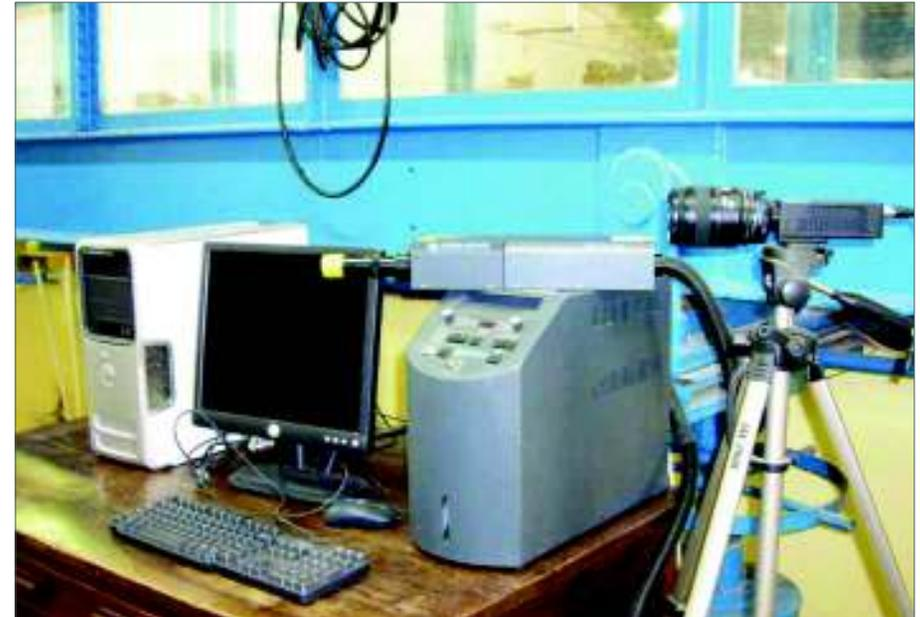
Sistema PIV en el Laboratorio de Hidráulica
