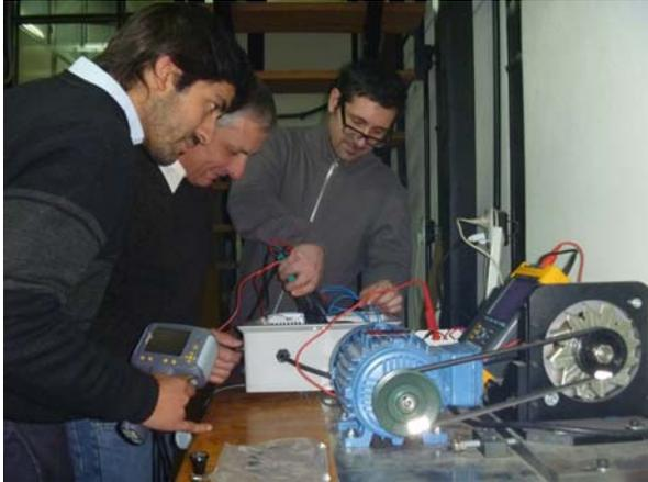
Fig. 8: Banco 1 para mediciones eléctricas y térmicas.
