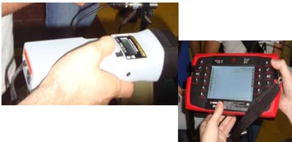
Fig. 6: Lámpara estroboscópica y Data Logger.
