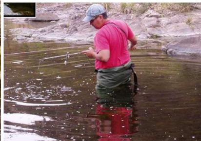
**Figura 2.** Instrumental de aforo utilizado en los ríos tributarios del Embalse San Roque (ESR)
