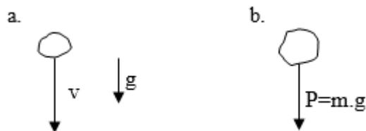
**Figura 3.8:** Un cuerpo en caída libre experimenta una aceleración, y la dinámica interpreta como que sobre el cuerpo actúa una fuerza. A esta fuerza se la denomina fuerza peso.
